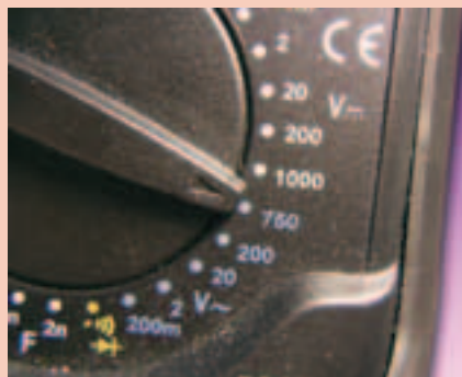
Рис. 2 Прозваниваем диодный мост. Какой щуп к какой ножке прикладывать - неважно, проверять надо в обе стороны. В одну сторону сопротивление должно быть порядка 500 Ом, в обратную - больше мегаома. Диод должен прозваниваться при подключении красного щупа к аноду, а черного к катоду. Соответственно, ориентируясь по схеме выпрямителя на принципиальной схеме, прозванивать надо ножки: 1-2, 1-3, 2-4, 3-4.
