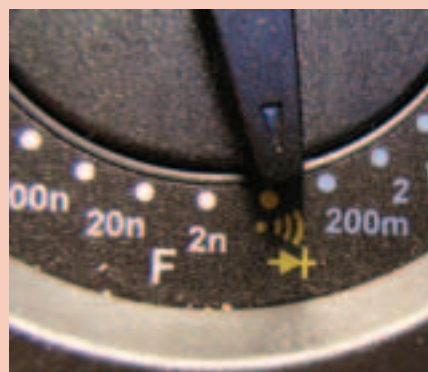
Регулятор выставлен в режим прозвонки.
