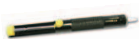
Опловотсос. Очень удобная штука для выпайки радиоэлементов из схемы.
