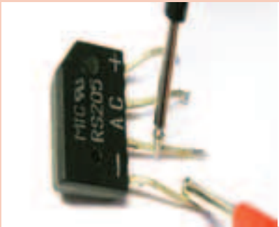
Рис. 2 Прозваниваем диодный мост. Какой щуп к какой ножке прикладывать - неважно, проверять надо в обе стороны. В одну сторону сопротивление должно быть порядка 500 Ом, в обратную - больше мегаома. Диод должен прозваниваться при подключении красного щупа к аноду, а черного к катоду. Соответственно, ориентируясь по схеме выпрямителя на принципиальной схеме, прозванивать надо ножки: 1-2, 1-3, 2-4, 3-4.
