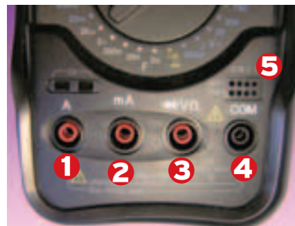
В зависимости от того, куда подключены щупы, будут производиться разные измерения. Черный щуп вставляется в 4 гнездо, как ты видишь, на фотографии оно тоже черное. Щупы можно вставить и наоборот - от этого ничего не изменится, различие по цветам сделано для удобства.
