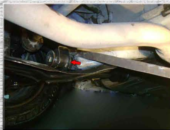
3. Монтажкой отодвинуть правый рычаг от кузова, приблизительно на 5 мм;
