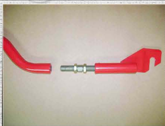
6. Раскрутить усилитель жесткости на две части;
