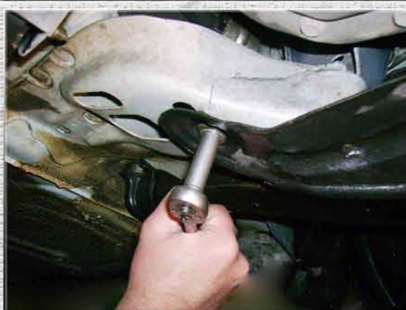
5. Открутить болт крепления защиты;
