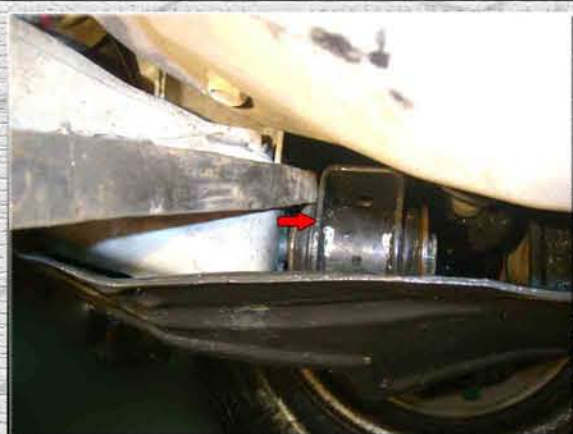
4. Монтажкой отодвинуть правый рычаг от кузова, приблизительно на 5 мм;
