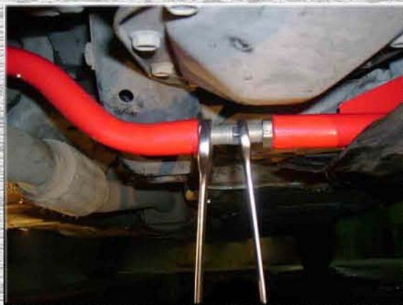
17. Зафиксировать размер усилителя жесткости левой контрящей гайкой на регулировочной шпильке;
