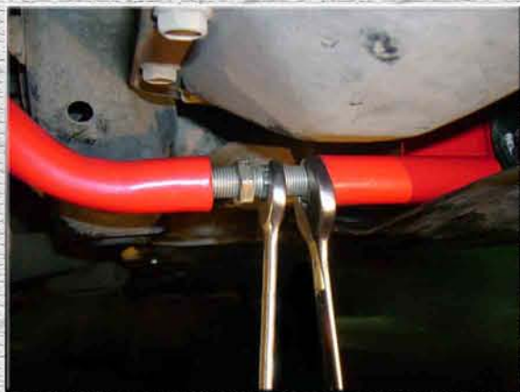
16. Зафиксировать размер усилителя жесткости правой контрящей гайкой на регулировочной шпильке;
