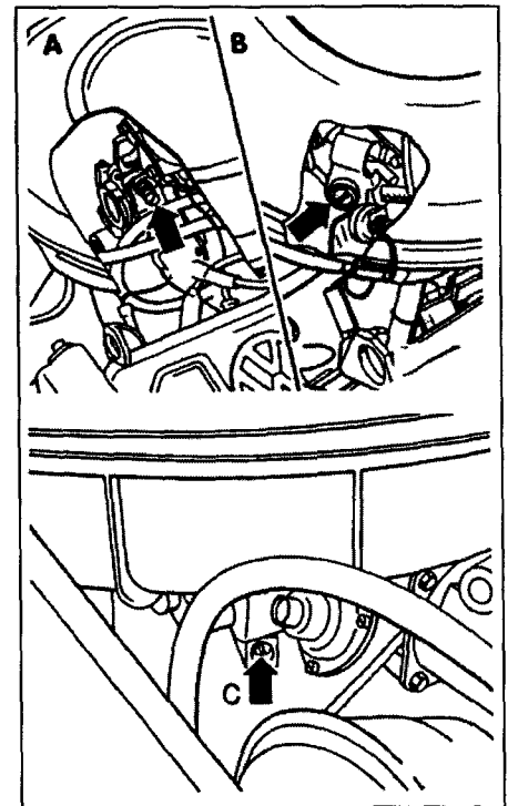
Рис. 4.6 Регулировка холостого хода
