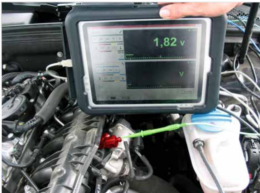
Измерение выходного напряжения на сенсоре давления во впускной трубе (выделенно другим цветом) в Audi A4 TFSI
