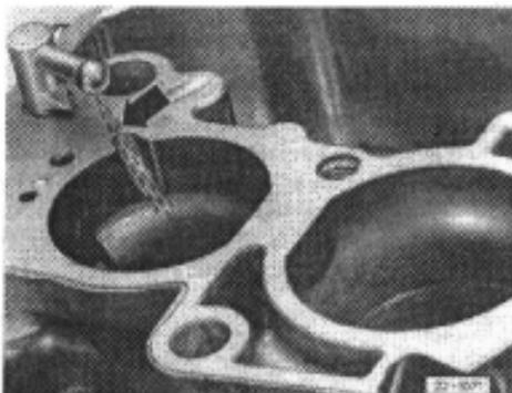
\* Поток топлива должен впрыскиваться в направлении выемки (стрелка)
