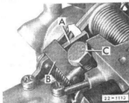
\* Рычаг прогрета -А- поворачиваем настолько, чтобы шток привода дроссельной заслонки не касался его и фиксируем рычаг прогрета в этом положении; для этого зажимаем болт -С- (например, М8х20) между рычагом и корпусом карбюратора.
