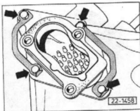
**Внимание:** с 12.1984г. винты крепления для резинового фланца (стрелки) страхуются специальными жестяными прокладками. Если был снят резиновый фланец, то винты следует затягивать с усилием 13Нм и отогнуть край страховочной прокладки, как показано на рис. Страховочной прокладкой также оснащались и автомобили более раннего выпуска.
